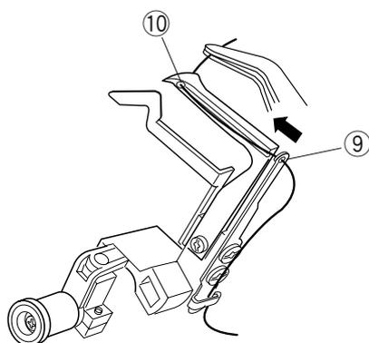
3 Удерживая нить с двух сторон, вставьте ее между дисками натяжения, немного натяните. (Если поднят рычаг прижимной лапки, нить легко пройдет между дисками натяжения).
