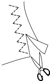
Этот стежок используется для отделки необработанного края синтетических и других тканей, которые могут морщиться. Расположите ткань так, чтобы обеспечить шов 1,6 см. После прошивки обрежьте припуск на шов. Страйтесь не порезать строчку.
