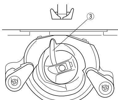
При установке шпульного колпачка установите челнок в паз челночного механизма.
