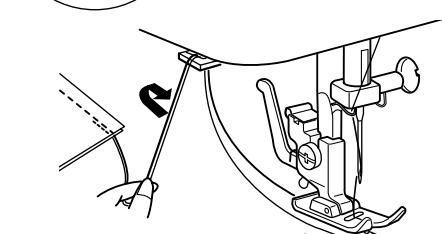
3 Обрежьте нитки нитеобрезателем. Теперь нитки имеют правильную длину для того, чтобы начать следующий шов.
