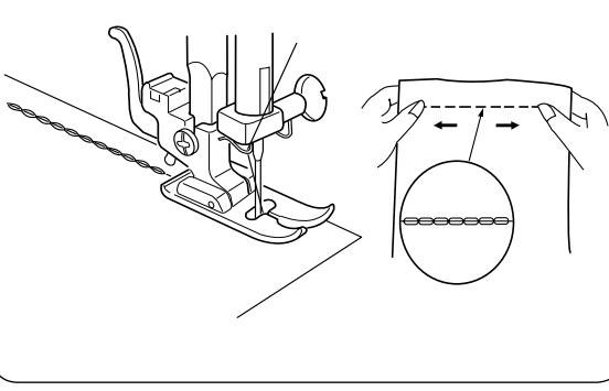
Этот прочный эластичный стежок рекомендуется применять там, где для обеспечения комфорта и прочности необходимы как эластичность, так и прочность.
