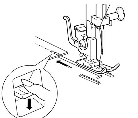
2 Для закрепления концов швов нажмите рычаг обратных стежков и прострочите несколько обратных стежков прямой строчки. Поднимите прижимную лапку и снимите ткань, протягивая нитки назад.
