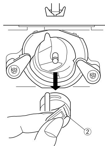
Поднимите иглу, поворачивая маховик к себе. Удерживая защелку, извлеките шпульный колпачок.
