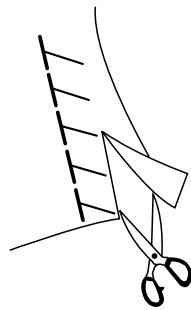
Этот трикотажный стежок идеально подходит для шитья купальных костюмов и эластичного велюра, т.к. он обеспечивает самую высокую степень эластичности и прочности. Расположите ткань так, чтобы обеспечить шов 1,6 см. После прошивки обрежьте припуск на шов. Страйтесь не порезать строчку.
