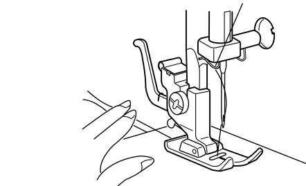
1 Поднимите прижимную лапку и расположите ткань так, чтобы ее край был выровнен по разметочной линии шва на игольной пластинке. Опустите иглу на ткань. Опустите прижимную лапку и разгладьте нитки назад. Нажмите педаль. Слегка направляйте ткань вдоль разметочной линии шва так, чтобы ткань перемещалась сама.
