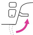
Выключите машинку ("O"). Поднимите прижимную лапку.
