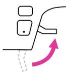
1. Включите машину ("I"). Поднимите прижимную лапку.
