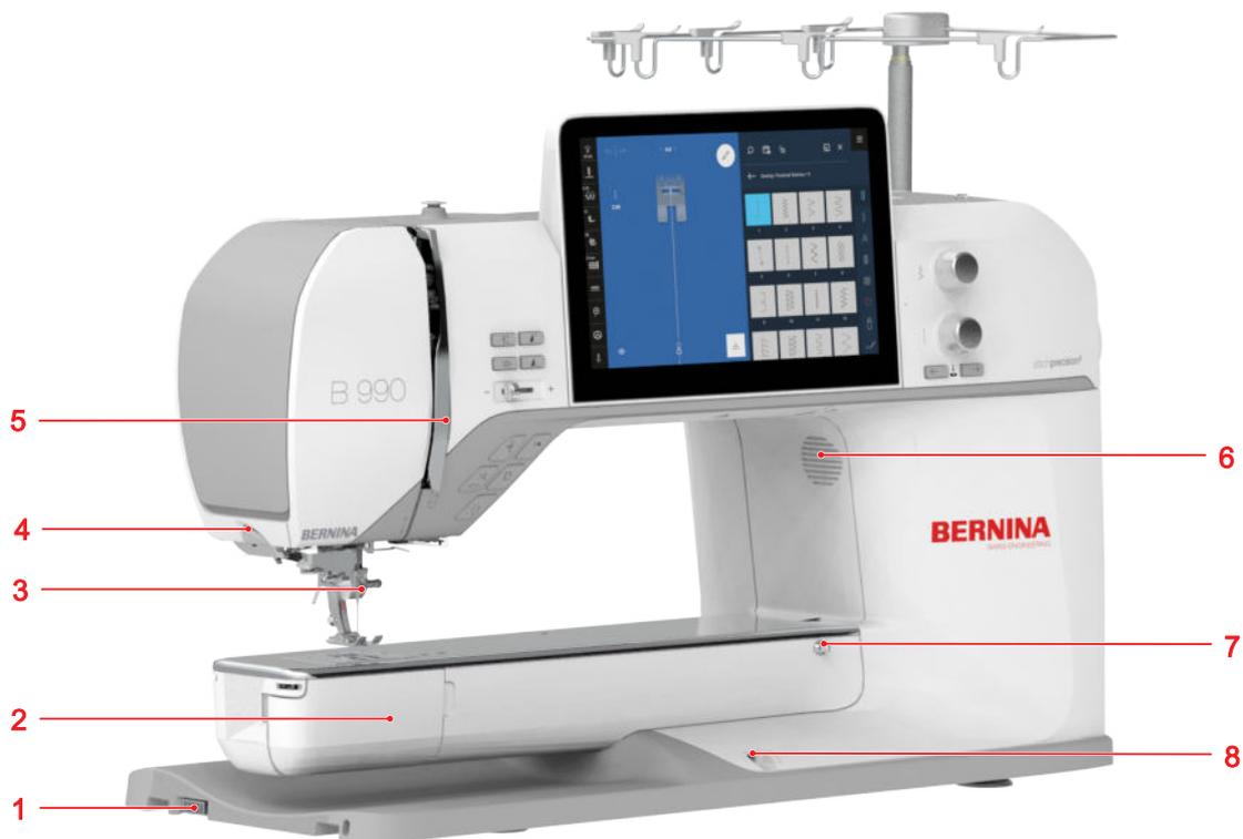
1 Гнездо вышивального модуля 2 Крышка петлителя 3 Область иглы 4 Нитеобрезатель 5 Крышка нитепротягивателя 6 Громкоговоритель 7 Разъем для приставного столика 8 Гнездо для коленного рычага
