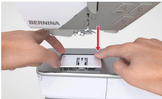
4. Снимите игольную пластину.
