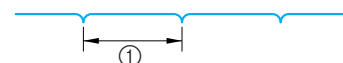
① Длина стежка в пределах от 5 мм (около 3/16 дюйма) до 30 мм (около 1-3/16 дюйма)
