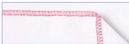
Узкий 3-ниточный оверлок
