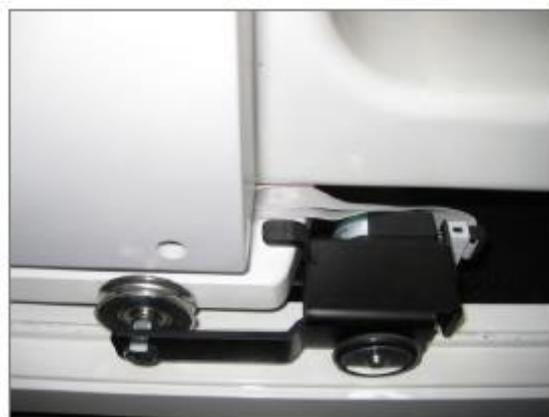
**ВАЖНО:** Если машину необходимо снять с каретки, сначала отсоедините кабель от датчика положения каретки. Остальные два разъема на кабеле должны оставаться на месте. Если этого не сделать, возможно повреждение кабеля, датчиков положения и каретки.
