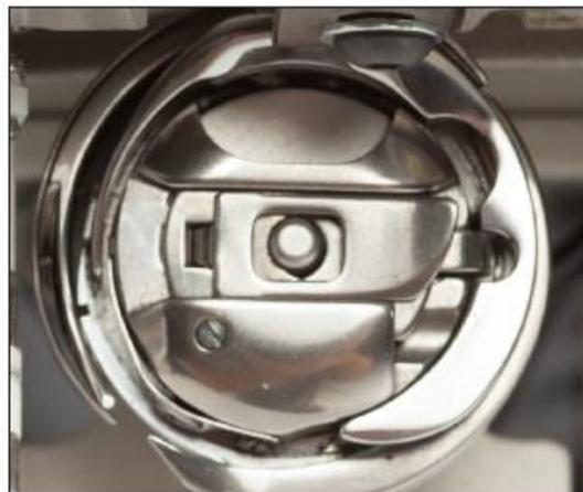
**ПРИМЕЧАНИЕ:** Не используйте при установке рычажок на шпульном колпачке. Используйте рычажок только для снятия шпульного колпачка.
