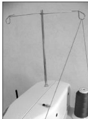
**ПРИМЕЧАНИЕ:** проушины стойки должны быть сцентрированы над катушечными стержнями во избежание образования конуса, наклона и проблем с натяжением нити.
