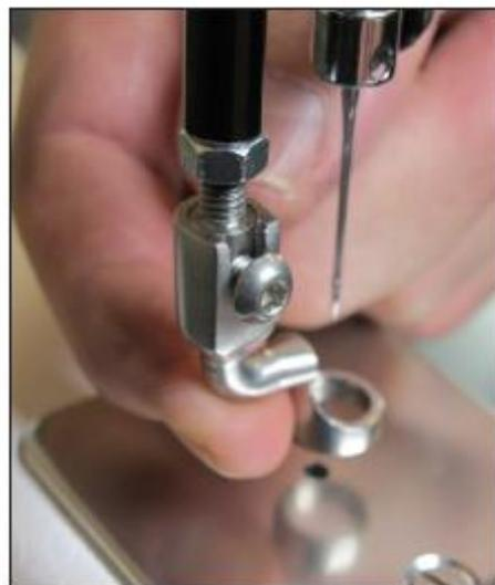
3. Убедитесь в том, что лапка сцентрирована по отношению к игле, винт крепления полностью затянут шестигранным ключом. В противном случае, ослабьте контргайку, сцентрируйте лапку по отношению к игле и, удерживая ее в этом положении, надежно затяните контргайку.
