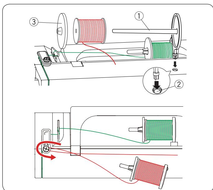
Используйте специальный катушечный держатель для катушек нестандартного размера, как показано. Нестандартный размер катушек варьируется: в диаметре отверстия – от 9,5 до 10,5 мм и в длине от 70 до 75 мм.
