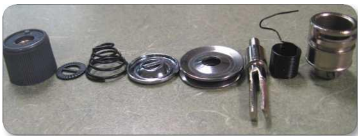
Илл. 1.9. Полная разборка, детали выложены по порядку.
