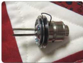
Илл. 1.7. Фиксирующая шайба и сдвоенная конусная пружина
