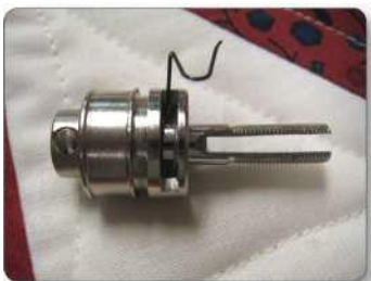
Илл. 1.8. Снятые диски натяжения (два ракурса)
