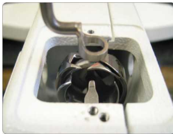
Илл. 9.7 Шпулеприемник повернут на 180 градусов вниз, Не мешает настройке зазора иглы
