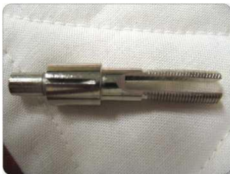
Илл. 1.10. Болт с раздвоенным концом механизма натяжения нити.
