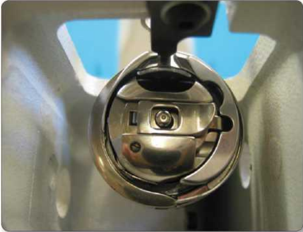
Илл. 9.5 Выдвинутый упор с установленным шпульным колпачком
