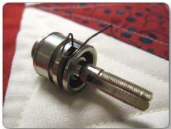
Илл. 1.8. Снятые диски натяжения (два ракурса)
