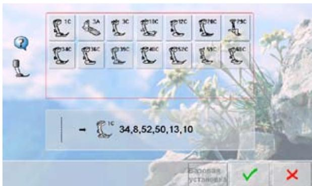
► для каждого выбранного образца стежка указывается номер рекомендуемой лапки в поле отображения стежков
