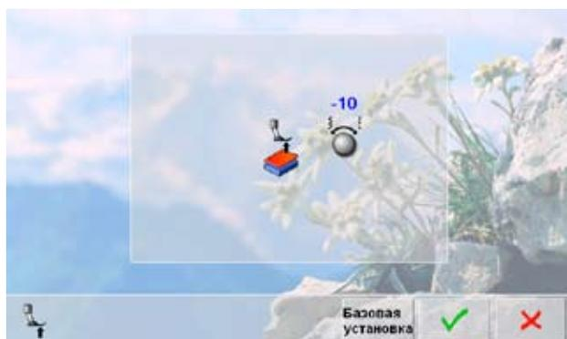
▶ При обработке толстого материала (например, при квилтинге) можно ослабить прижим лапки путем поворота одной из ручек влево в сторону минуса
