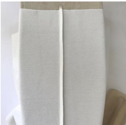
Выполнить влажно-тепловую обработку (далее – ВТО) плечевых и боковых швов на универсальной колодке, первоначально приутюжив их, а затем заутюжив припуски в сторону спинки.
